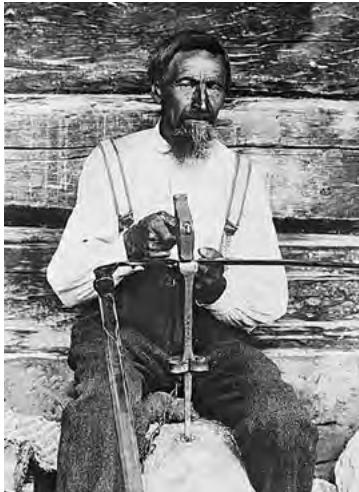
St. Antönier Bauer am Dengeln: Durch gezielte Schläge wird das Sensenblatt in einem schmalen Streifen entlang der Schneidkante ausgezogen, verdünnt und somit geschärft (um 1900).
